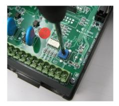
vite regolazione pressostato
